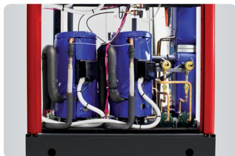
In der Baureihe **KSW** wird die Multiscroll-Lösung auch für den Einzelkreislauf, elektronische Expansionsventile, Plattenwärmetauscher und die Möglichkeit, die Umwälzpumpen (extern) über die dedizierte Software zu verwalten, angewandt. Dank all dieser Eigenschaften lässt sich bei Teillasten eine hohe Energieeffizienz erreichen.
